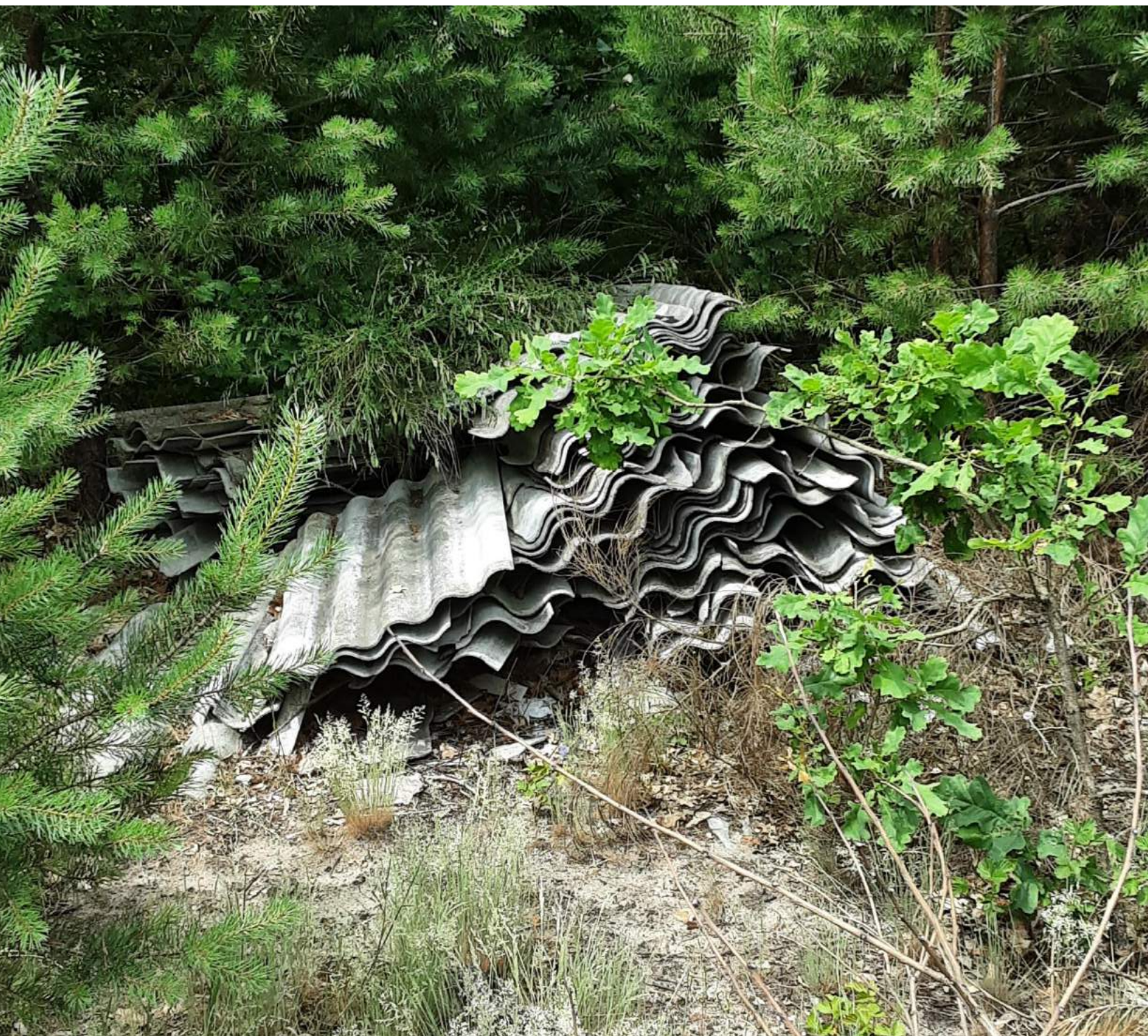
Fot. 2. Nielegalne składowanie wyrobów azbestowych.
